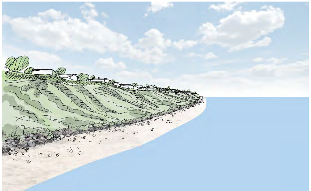
Figur 2.1: Overordnede kysttekniske princip for kystbeskyttelsesprojektet Nordkystens Fremtid, som omfatter strandfodring med sand, grus og ral (Kilde: Kystteknisk Skitseprojekt, 2016).
