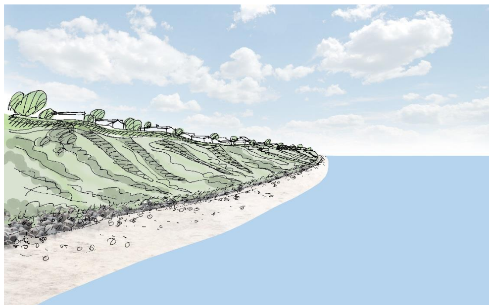
Figur 2-5 Overordnede kysttekniske principper for den foreslåede helhedsplan for kystbeskyttelsen på Nordkysten omfatter strandfodring med sand, grus og ral kombineret med skråningsbeskyttelser af sten
