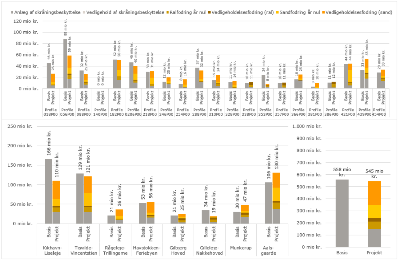
Figur 3.3: Basisscenaariets og projektscenaariets omkostninger i tilfælde af ralfodring op til +1,2m i forhold til middelhavspejlet samtidig med, at alle andre parametre er lig middelværdien i Tabel 2.1. Beløb er afrundet. En større version af figuren ses i Bilag C.
